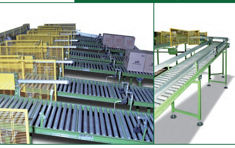
I trasportatori a rulli folli possono avere rulli di diametri a passi differenti in relazione al tipo di prodotto movimentato, da un minimo di Ø30 mm ad un massimo di Ø60 mm.
